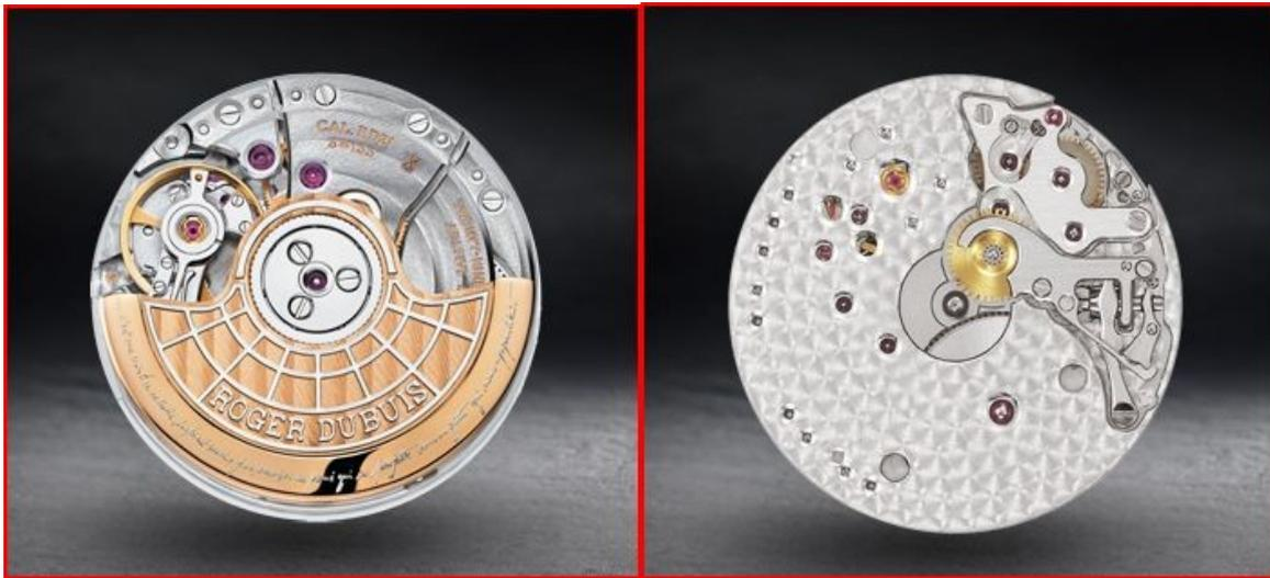
L'accent a particulièrement été mis sur la lubrification, celle-ci ayant pour but de réduire au maximum les frottements des pièces en mouvement, d'optimiser le fonctionnement, la longévité et bien-sûr la précision du mouvement.
